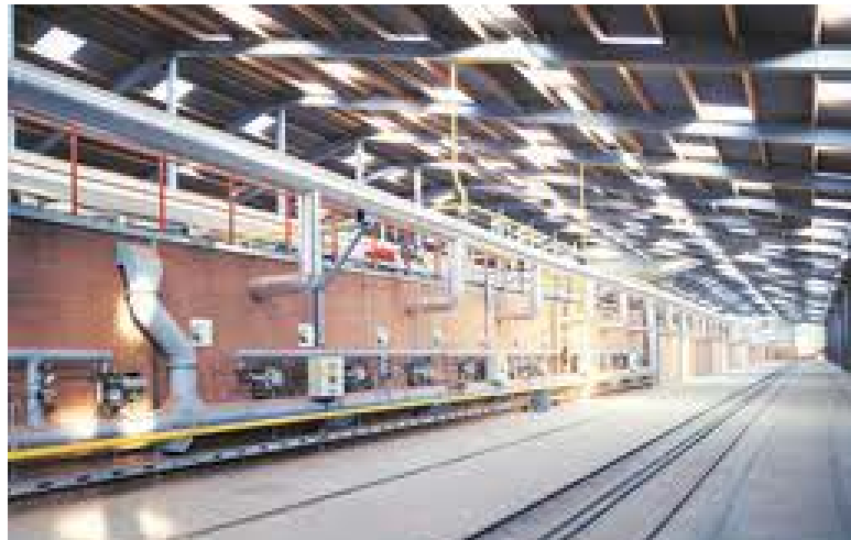
Four à tunnel avec des brûleurs latéraux
