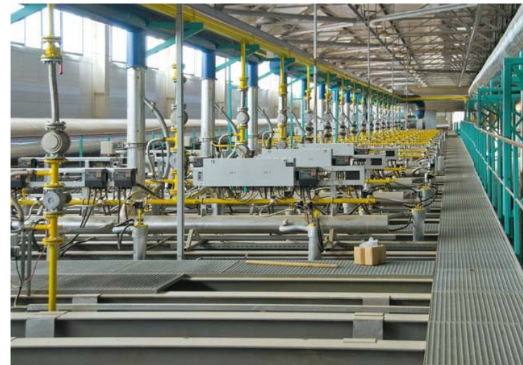
Four à tunnel avec des brûleurs verticaux
